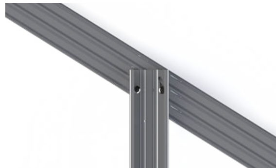
Figura 9: Posicionamento da tesoura no pilar (2)
